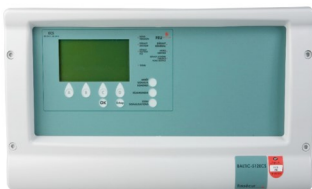
ECS Adressable 512 points et CMSI Réf : BALTIC 512 ECS/CMSI Comprenant : › 4 lignes bouclées de 128 points ou 8 lignes › ouvertes de 32 points › Auto-codage des points › 1 fonction UGA intégrée › 3 fonctions paramétrables › CMSI avec contrôle de position › Livré avec batteries › Coffret ABS Blanc › Autonomie 24H
